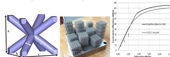
Fig.11 Comparaison modèle-expérience du comportement élastique en compression de la structure
