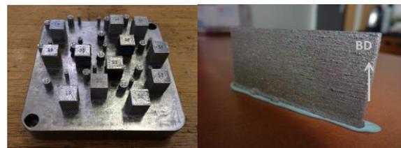
Fig 4 : Echantillons TiXNb obtenus à partir de la poudre pré alliée et le mélange de poudre
