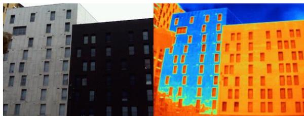
Figure 1 – Exemple d'image thermique de la façade extérieure de bâtiments de revêtements d'émissivité différente
