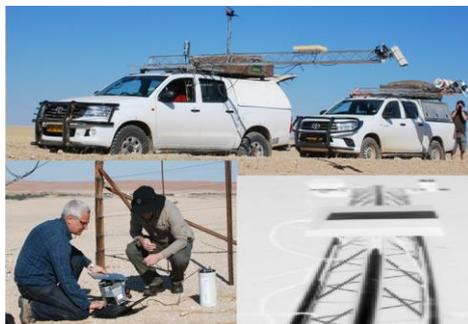
Figure 2 – Mesures d'émissivité et par thermographie IR sur le site de Gobabeb en Namibie
